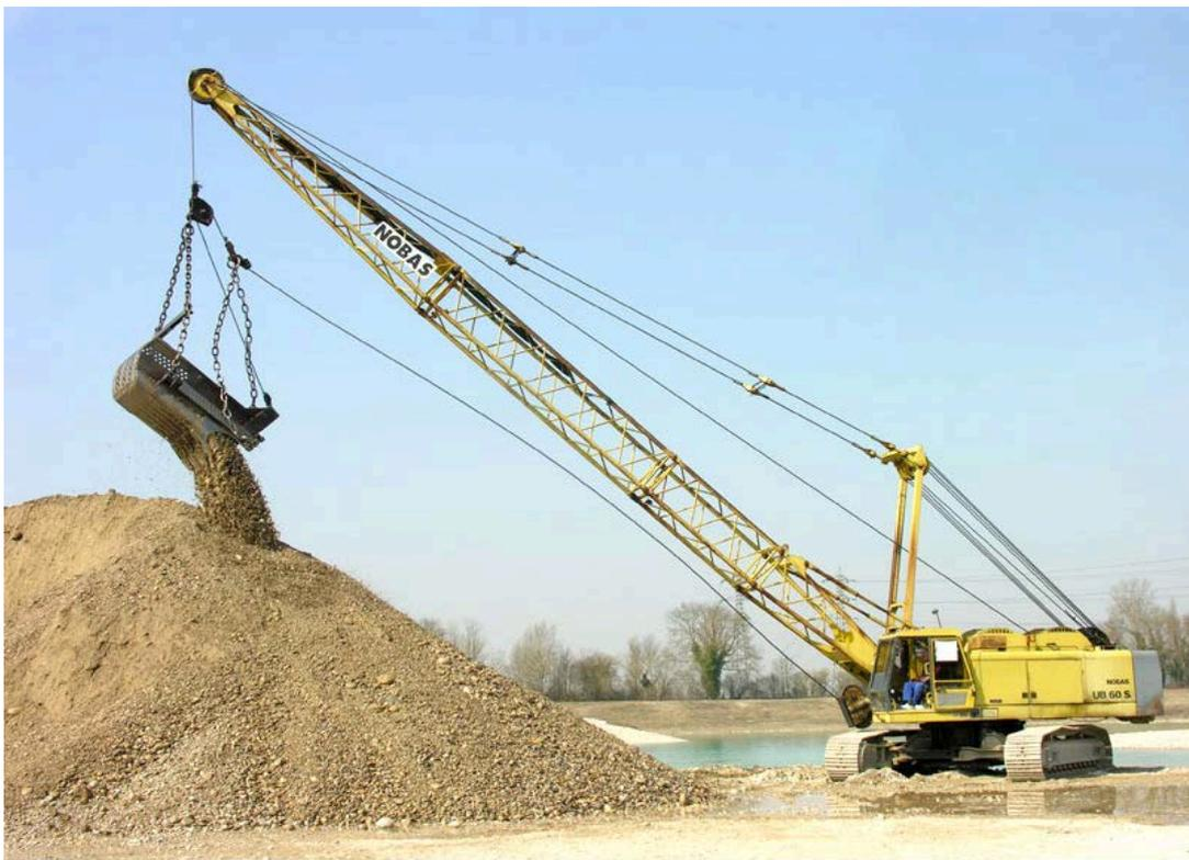
**Figure 6:** Extraction avec une dragueline (source : Vicat)
