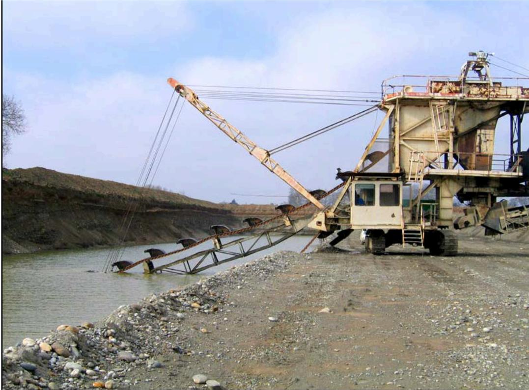
**Figure 7:** extraction avec une drague à godet (source : Vicat)
